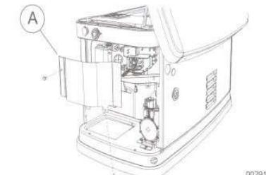
Рисунок 1. Снятие крышки панели клиентских соединений (устройства 2016 г.).
