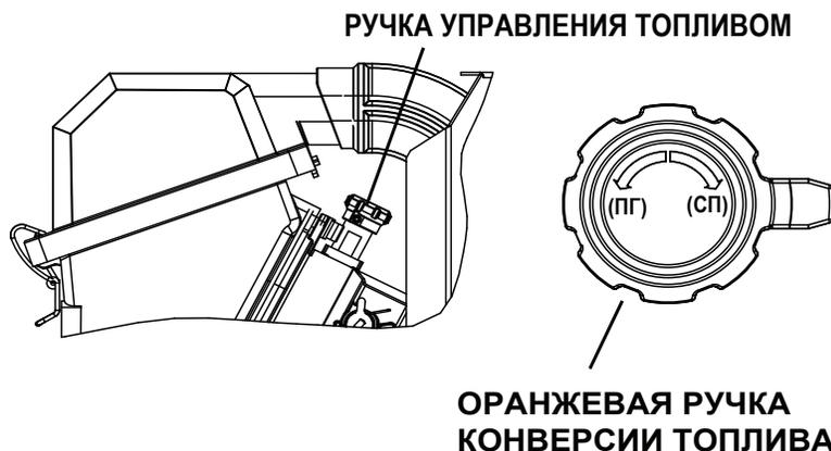
Рисунок 5.1. — Расположение ручки конверсии топлива для одно- и двухцилиндровых генераторов
