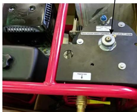
6. Включите зажигание в положение «ON». Затем поверните ключ в положение «START». Если двигатель не запустился с первого раза, необходимо выключить зажигание, выдержать паузу 10-20 сек. и повторить попытку запуска;
