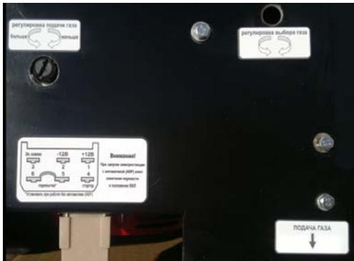
Если генератор оснащен разъемом для подключения блока автоматики, для работы в автономном режиме поставьте перемычку. Соедините газовую магистраль с входным штуцером электрогенератора;
