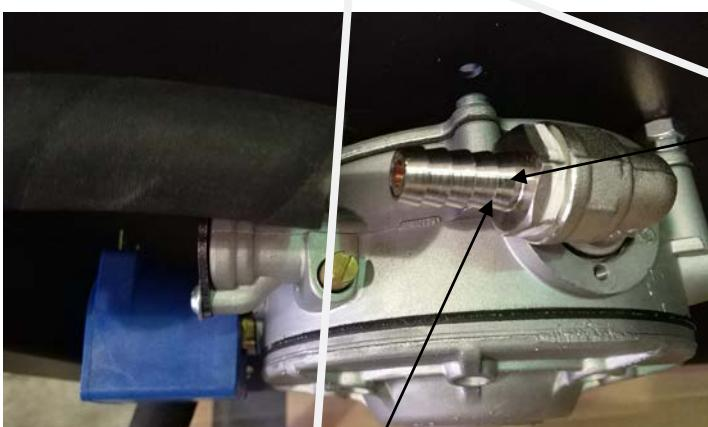
Установите штуцер соответствующего цвета на редуктор (в большинстве случаев на производстве ставится штуцер под пропан-бутан, на метан поставляется в комплекте). Желтый – природный газ(метан).
