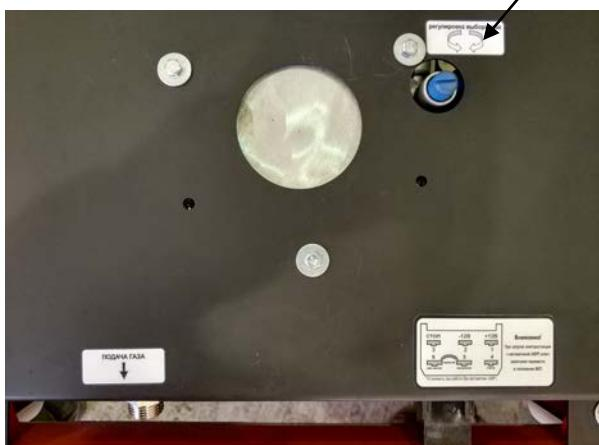
положение «вкл». Добейтесь устойчивых оборотов двигателя с помощью регулировки винта «Регулировка выбора газа». Подсоедините нагрузку примерно 30% и добейтесь корректной работы двигателя при помощи регулировочного винта «Регулировка подачи газа» включая и отключая нагрузку. Затем подключите полную нагрузку и при необходимости дорегулируйте работу двигателя при помощи винта «Регулировка подачи газа».
