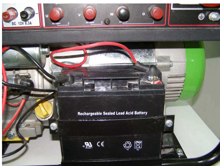
Рис.01. Подключение аккумуляторной батареи к генератору
