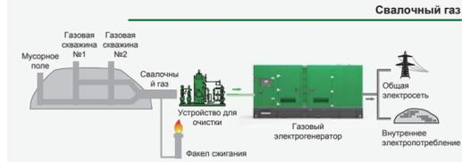
Использование биогаза после предварительной очистки в качестве топлива для электрогенераторной установки, дает возможность экономного производства электроэнергии с высоким уровнем экологичности.
