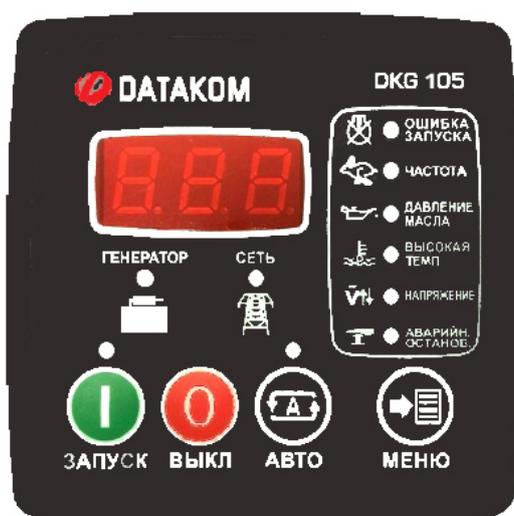
Контроллер DKG-105 является цифровым микропроцессорным устройством, имеющим все функции, необходимые для автоматического управления ГУ.
