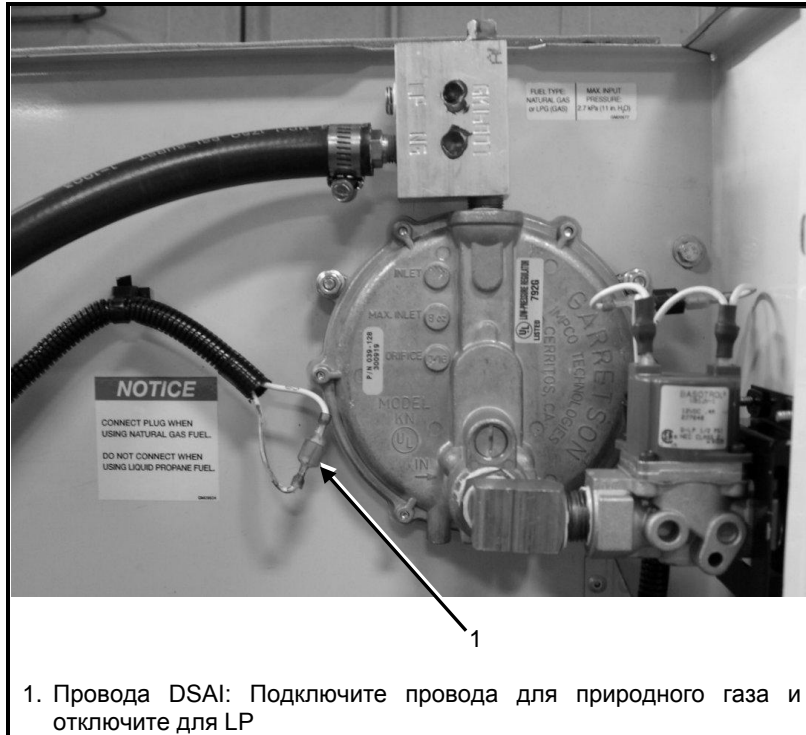
Рисунок 2.21: Провода модуля DSAI (Digital Spark Advance Ignition), находяты в области входа воздуха на генераторе
