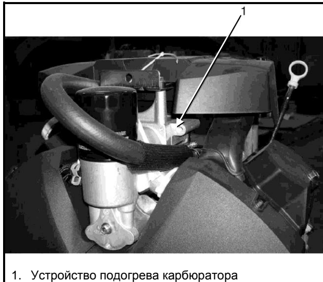
Рисунок 2.30: Устройство подогрева карбюратора, на двигателе, RES 18 EC / RES 16 TEC
