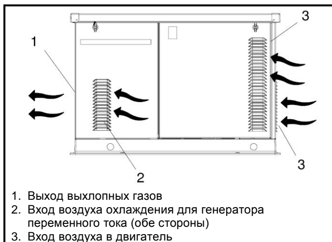
Рисунок 2.11: Входы и выходы воздуха охлаждения
