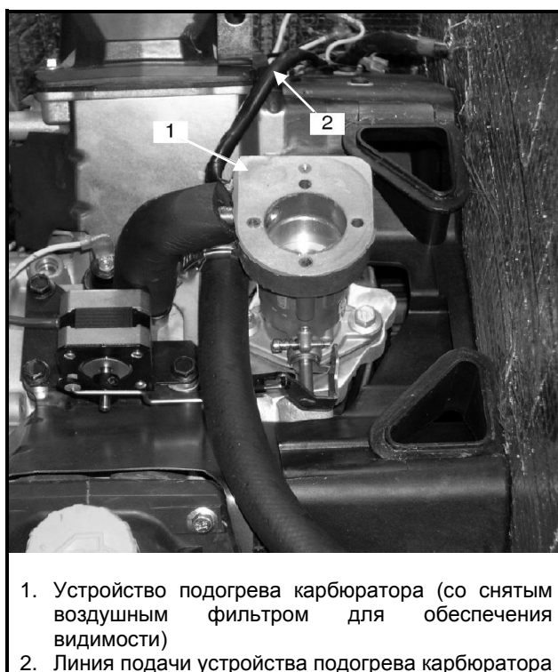
Рисунок 2.29: Устройство подогрева карбюратора, RES 9.5 EC / RES 13 EC / RES 12 TEC
