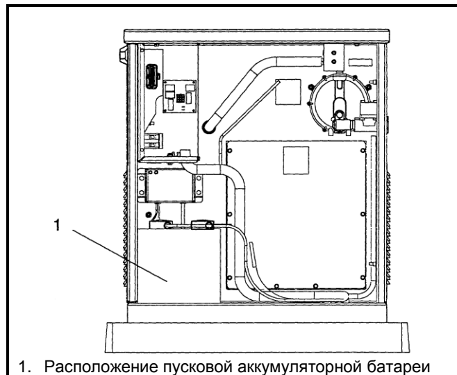
Рисунок 2.28: Расположение аккумуляторной батареи со стороны впуска воздуха
