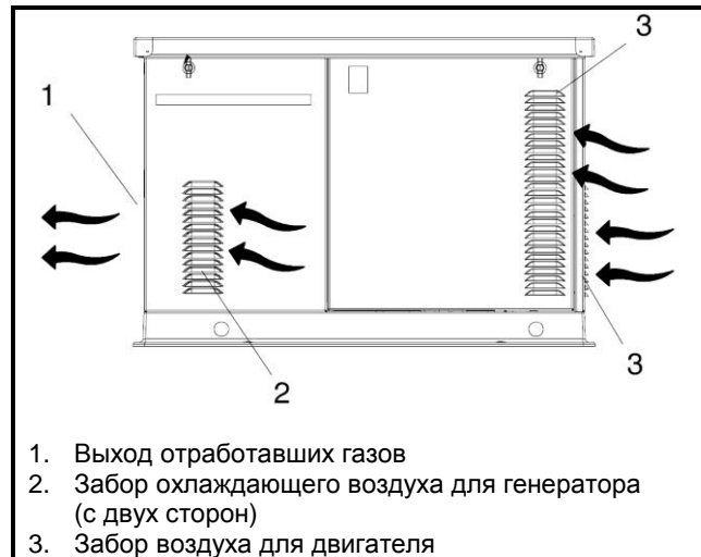
Рисунок 4.7: Входы и выходы охлаждающего воздуха
