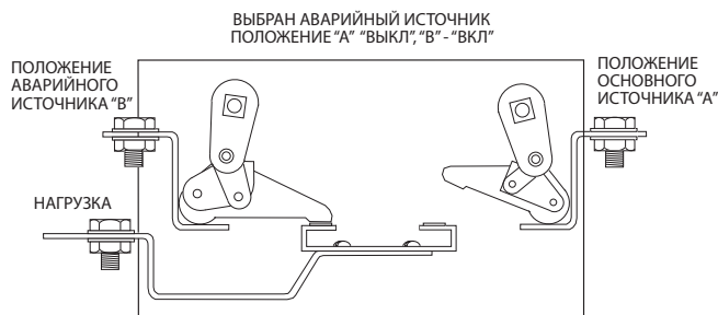
Рисунок 3.5 — Основные контакты при соединении с резервным (аварийным) источником.
