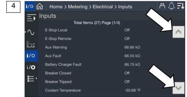
Figure 24 Inputs Metering Screen
